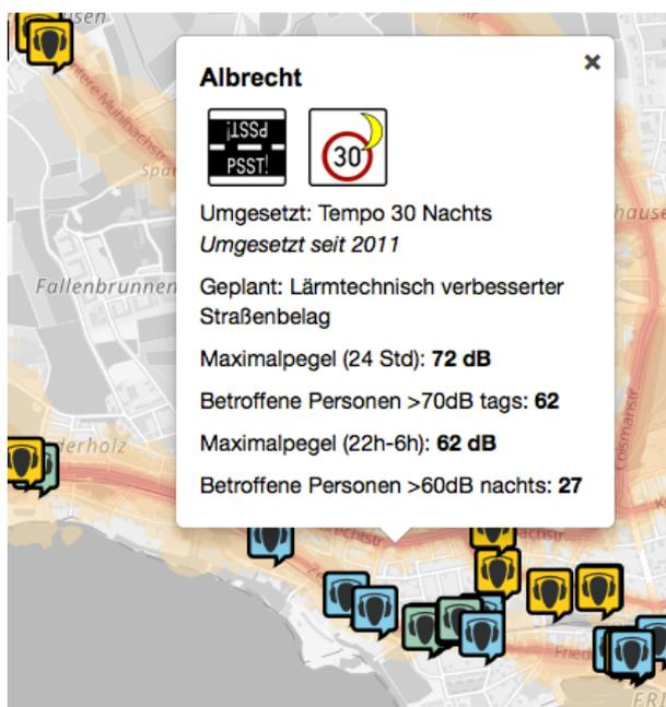
Abbildung 2: Anzeige der ermittelten Lärmwerte, bereits umgesetzter und geplanter Maßnahmen, Lärmaktionsplan
